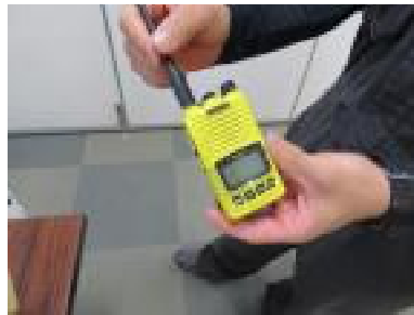
2 上部ジャックにアンテナをねじ込む
