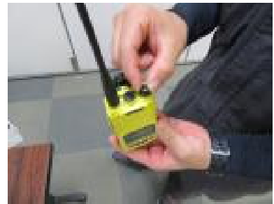
3 つまみを「カチッ」と音がするまで回し 適当な音量に調整する
