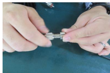
13 接続アダプターと同軸ケーブルの もう一方を接続する
