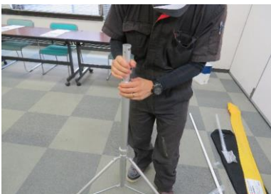
5 ケーブルが通りにくい場合は 写真の部分一度外すと通りやすくなる
