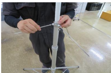
11 ラジアルエレメントをねじ込む（3箇所）
