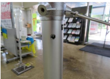
8 アンテナを三脚に差し込む （ネジ穴の位置が合うように）
