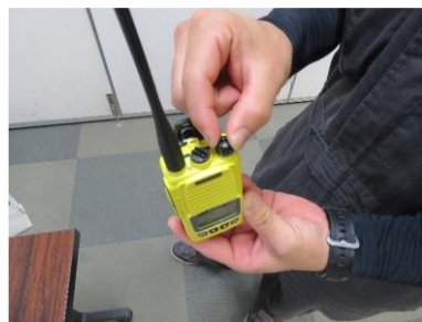
3 つまみを「カチッ」と音がするまで回し 適当な音量に調整する
