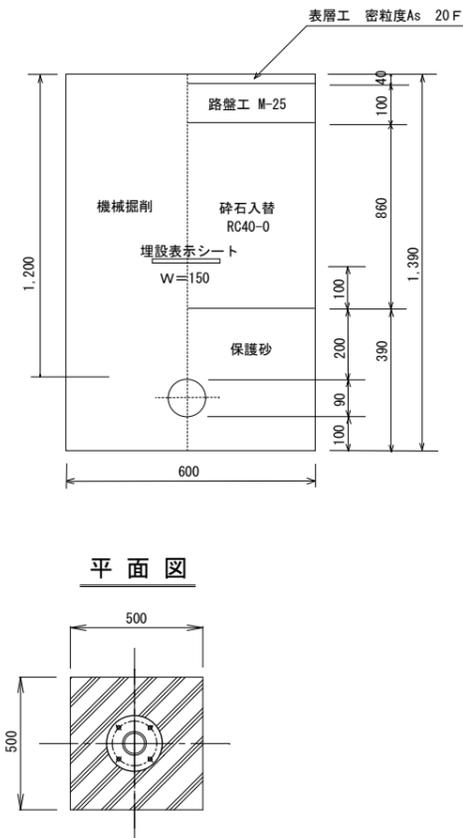
地上式消火栓（打倒式）標準設置図
