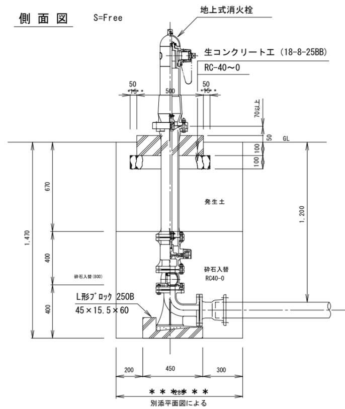
掘削断面図（道路部）
