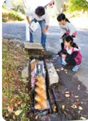
役場近くの水路に、らせん型水車の小水力発電が設置されました
