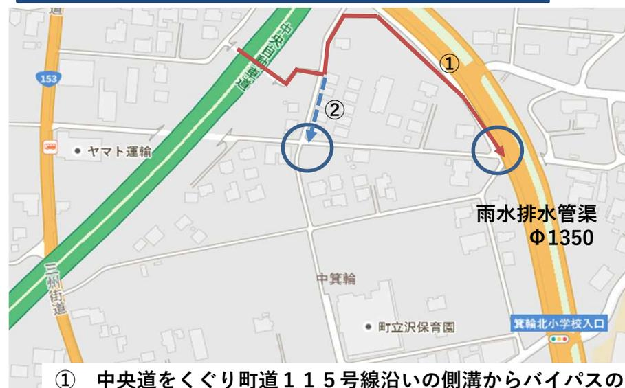
① 中央道をくぐり町道115号線沿いの側溝からバイパスの側道を使い既設の雨水排水管渠へ接続する側溝改修工事。(L=300m 工事費35,000千円、委託料20,000千円、用地費5,000千円)
