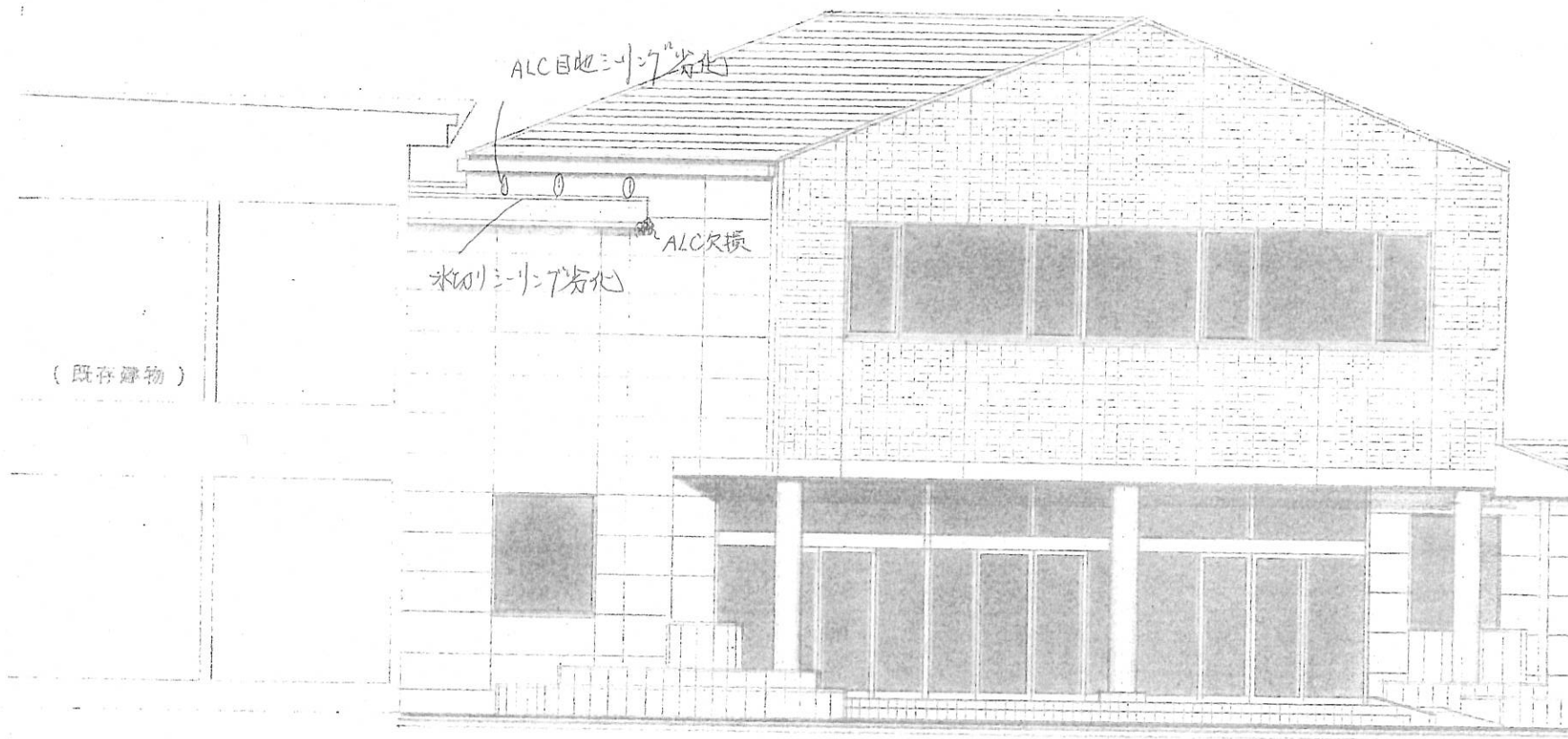
視聴覚室入口附近雨漏り調査
